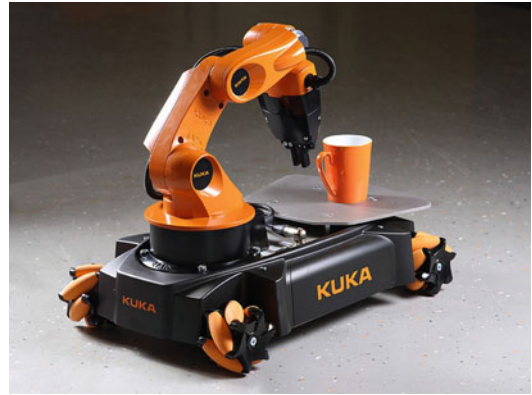
Redundant Robots, Fig. 5 The KUKA youBot
